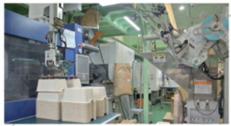
同じ機械でも金型を変え、さまざまな商品を製造できる
